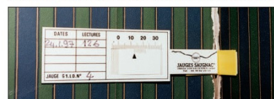
La cueillie fait un angle à 90°. Pose d'une jauge G1 avec cornière plastique
