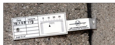
Pose d'une jauge G1 en cueillie verticale avec cornière aluminium fixée par tap-vis
